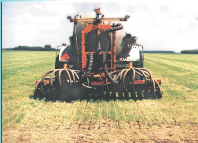
Fot. 10 Wprowadzanie gnojowicy bezpośrednio do gleby za pomocą węży rozlewowych połączonych z zębami kultywatora
