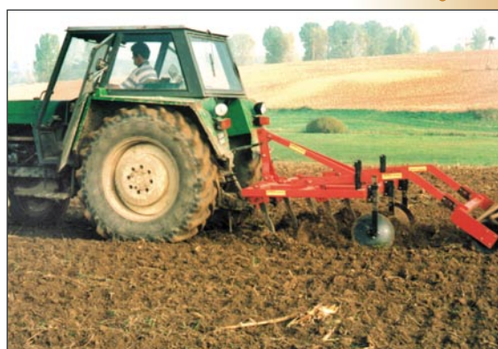
Fot. 12. Gruber – narzędzie niezbędne w uprawie bezorkowej
